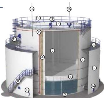
\* В качестве примера в каталоге представлена модель резервуара стального вертикального с pontoном и внешней защитной стенкой.
